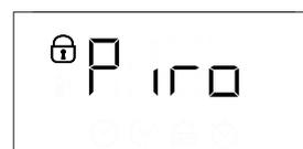
A ciclo ultimato, la porta rimane bloccata fino a quando non viene raggiunta una temperatura sicura. Ventilare la stanza durante e dopo il ciclo di pirolisi.
