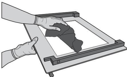
**3.** Riapplicare il vetro intermedio (contrassegnato con "R1") prima di rimontare il vetro interno: Per posizionare correttamente i vetri, verificare che la marcatura "R" sia visibile nell'angolo sinistro. Inserire dapprima il lato lungo del vetro contrassegnato con "R" nelle sedi di sostegno, quindi abbassarlo in posizione. Ripetere la procedura per entrambi i vetri.
